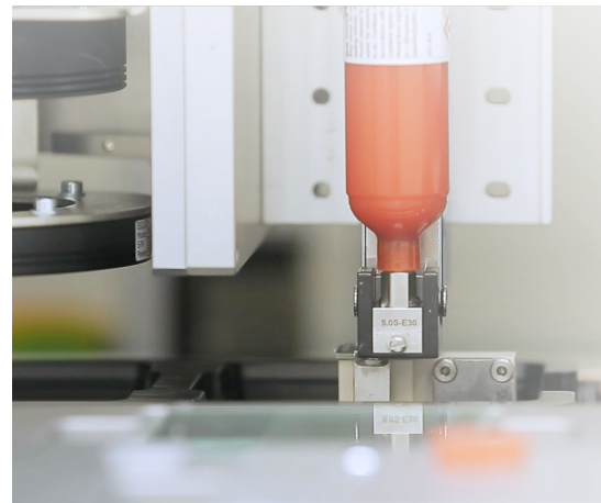
Trạm dán do robot điều khiển và hướng dẫn bằng thị giác máy, bên phải
